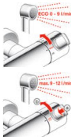
Per la regolazione continua della quantità d'acqua è sufficiente girare leggermente la manopola. Il tasto Eco permette inoltre di risparmiare acqua. Se si lascia la zona di risparmio idrico azionando il pulsante di arresto, viene erogata la portata massima d'acqua.
