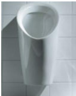
L'orinatoio Lema a 0 litri di LAUFEN funziona senz'acqua. Per tenere chiuso lo scarico non necessita di dispositivi di blocco dell'acqua, né di elettricità. L'urina stessa aiuta a trattenere gli odori e ne impedisce la fuoriuscita. Il principio di questa «trappola» è noto nell'industria chimica come matraccio di Erlenmeyer. L'orinatoio Lema a 0 litri di LAUFEN è particolarmente adatto laddove l'accesso all'acqua pulita non è direttamente disponibile o è comunque limitato.
